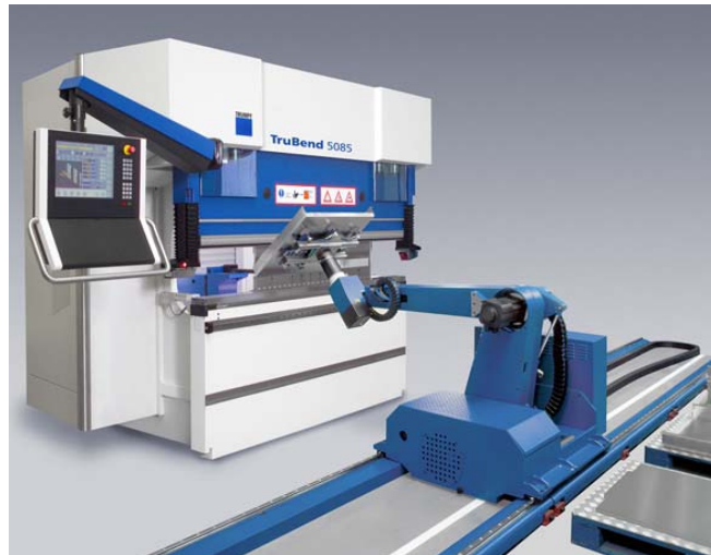
Slika 4.24- Hidraulična abkant presa Trumpf sa robotom za manipulaciju obratkom
