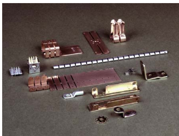
Slika 4.32- Delovi oblikovani višepozicionim alatom na hidrauličnoj presi Wanzke
