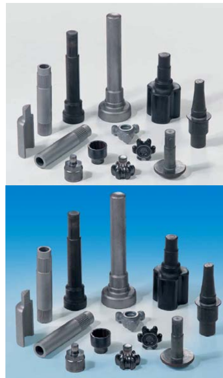
Slika 4.52- delovi izrađeni istiskivanjem na presi KFP
