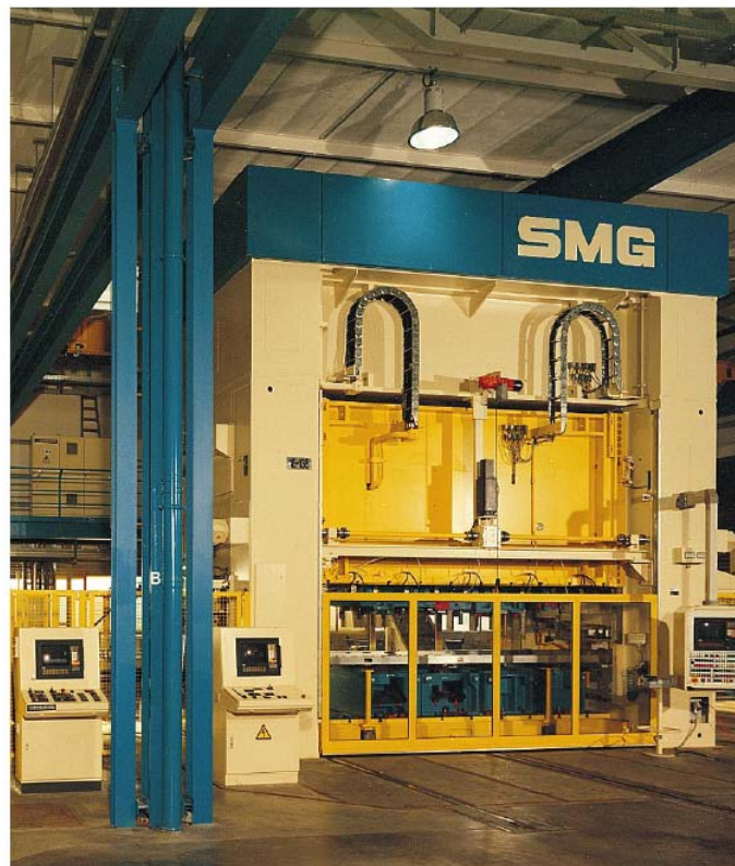
Slika 4.40- Višepoziciona presa Schuler Nominalna sila do 42 MN, broj pozicija 11, korak transportera 700 mm, broj hodova 10-28 /min.
