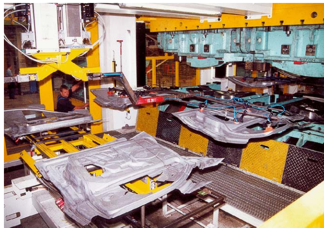
Slika 4.50- Transport obratka u automatskoj liniji sa međusklađištem
