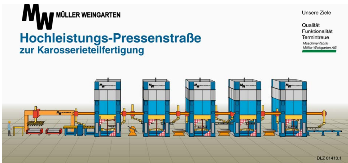
Slika 4.48- Automatska linija hidrauličnih presa za izradu delova karoserije Broj presa 5, dimenzije priprema 3600x1830mm, ukupna sila svih presa 54000 kN, broj hodova 14/min., dužina linije 38 m, širina linije 10,5 m, masa linije 2800 tona
