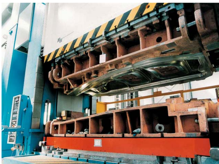
Slika 4.46 - Probna presa Müller Weingarten Nominalna sila do 30MN, širina stola do 5500mm,
