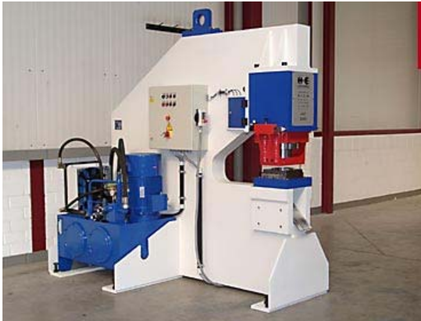
Slika 4.8 - Hidraulična presa za probijanje i prosecanje Hengstebeck & Eich GmbH & Co., Maschinenbau
