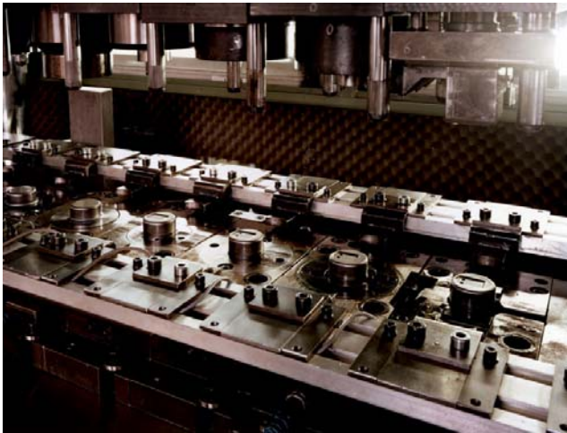
Slika 4.39 - Višepozicioni alat za izradu kućišta manometra (WANZKE)
